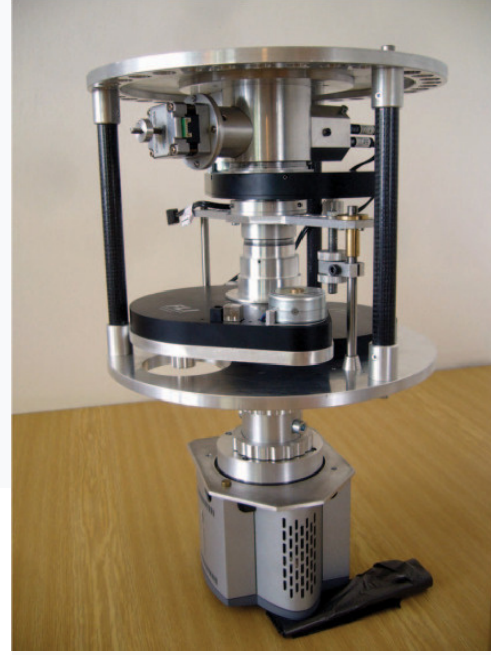
Şekil 1: ISTSPEC tasarımına temel oluşturan COLORES spektrografının mekanik yapısı
