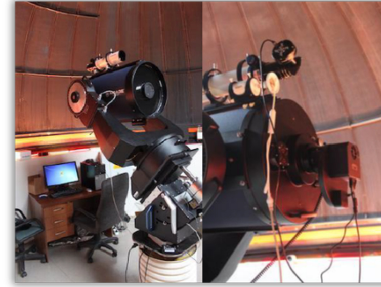
Şekil 1: İstanbul Üniversitesi Gözlemevinin İST40 teleskobu (sol) ve Moravian G2 CCD kamerası (sağ).
