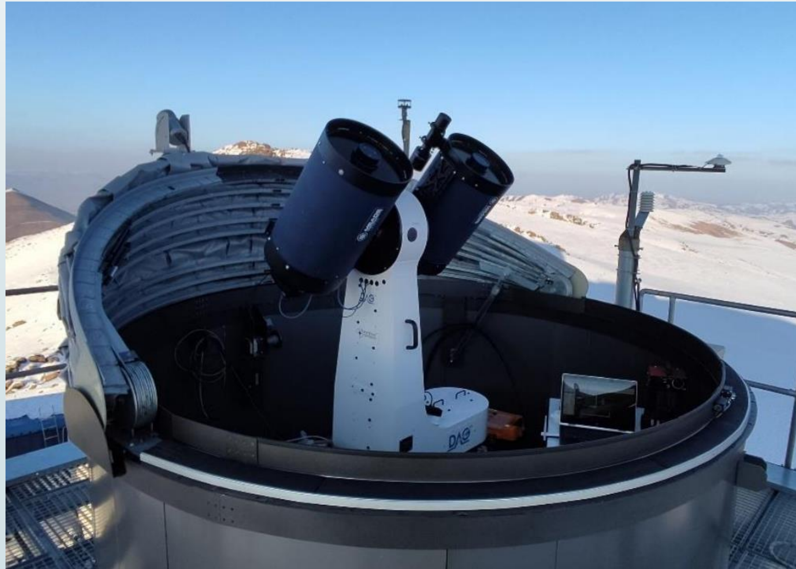
Fig 2. DAG-MAM kulesi üzerinde, DAG-TPS'ni oluşturan kubbe ve tek kundak üzerinde konuşlu iki optik tüpten oluşan MASS-DIMM ve G-DIMM sistemleri.
