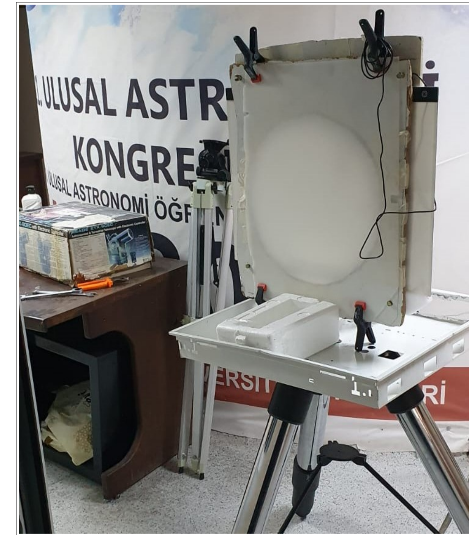
Figure 5: İkinci yöntemden elde edilen düz-alan paneli.
