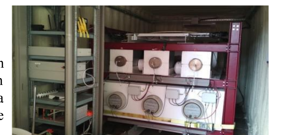
Şekil.7 Dedektörün yerleşimi ve ORCA deniz konteynerine kurulumu.
